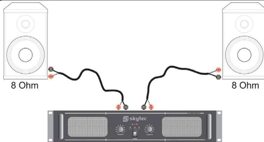
**Parallel aansluiting 4 Ohm / Connection in parallel 4Ω/ Connexion en parallèle 4Ω / Parallelanschluss 4Ω / Conexiones en paralelo 4Ω:**
